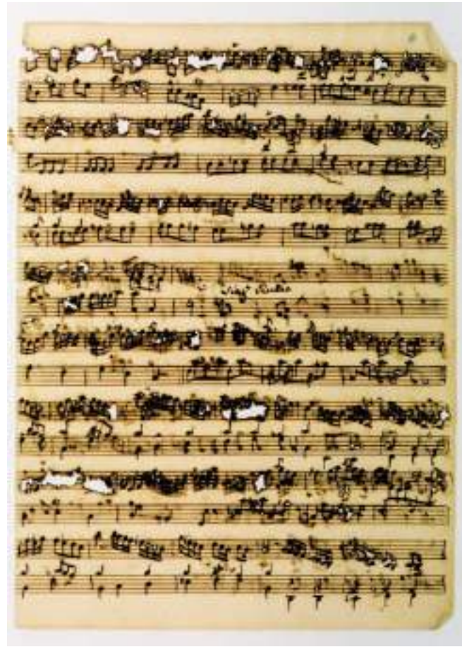
Starker Tintenfraß an einem Notenblatt aus einem Sammelband verschiedener Komponisten aus der Mitte des 18. Jahrhunderts (© SBB-PK)
